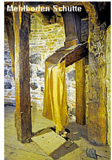
Unsere Besichtigung geht jetzt ein Stockwerk tiefer in den Mehlboden. Das Mehl gelangte durch die Mehrlutsche über die Schütte in die Mehlsäcke. Von hier wurde der volle Mehlsack über den Sackaufzug nach unten befördert. Zum Abschluss der Besichtigung lohnt noch einmal ein Blick aus der Fensteröffnung der Tür über die mittelalterliche Stadt Zons und seine Lage am Rhein.
